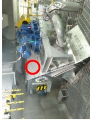
自動測定器の水素測定箇所をコンベヤテーブル部へ移設
