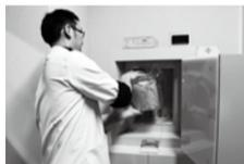
野菜等産地の移動や旬に合わせて対象を選びます。可食部分だけを細かく刻むなどして、ゲルマニウム半導体検出器により精密検査を行います(食材)
