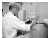
原水・浄水を採水後、専用容器に入れて、ゲルマニウム半導体検出器により精密検査を行います
