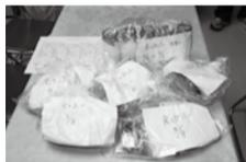
園児・児童・生徒の1人分×1週間分の実際に提供した給食が対象です。ミキサーにかけ調製し、専用容器に入れて、ゲルマニウム半導体検出器により精密検査を行います(提供食)
