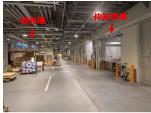
▲閉鎖型の卸売場・仲卸売場のイメージで、外壁にシートシャッターが設けられ、温度管理されている一連の空間で、卸売場と仲卸売場が配置されている（高松市中央卸売市場）
