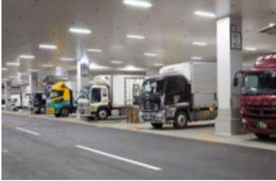
▲屋根・庇、荷捌きスペース確保のイメージで、ウイング車でも車両全体が屋根・庇下に入り、荷捌きができる場所を確保している（東京都中央卸売市場豊洲市場）
