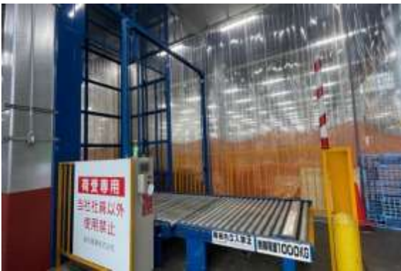
▲常温商品の上階保存のイメージで、垂直搬送機が備え付けられ、保管期間が長くなり常温管理が可能なじゃがいも・たまねぎ等を、空間を利用して上階に保存している（東京都中央卸売市場大田市場）
