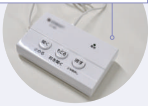
▲電話機の配線に取り付けます
