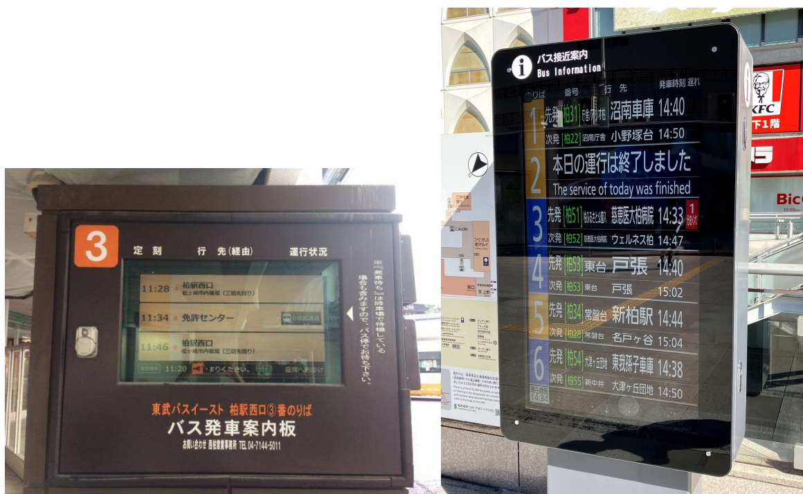
図 2-36 柏駅におけるバスロケーションシステムによる発車時刻案内 (左: 柏駅西口バス発車案内、右: 柏駅東口デジタルサイネージ)
