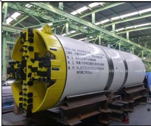
地中内を掘削するシールド機
