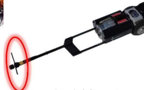
⑦レーザーによる塩ビ管の変形量計測
