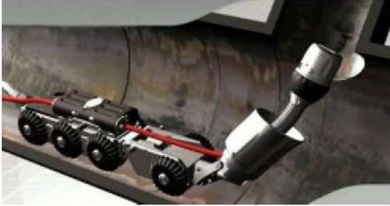
⑥サテライトカメラによる取付管の不明水調査
