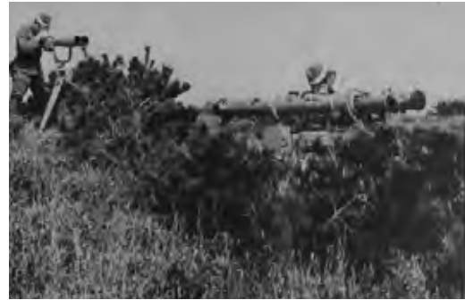
測高機（測遠機）で飛行機の位置を把握し、砲手に伝える。測遠機の価格は七万余円とある（右下の写真の一部拡大）
