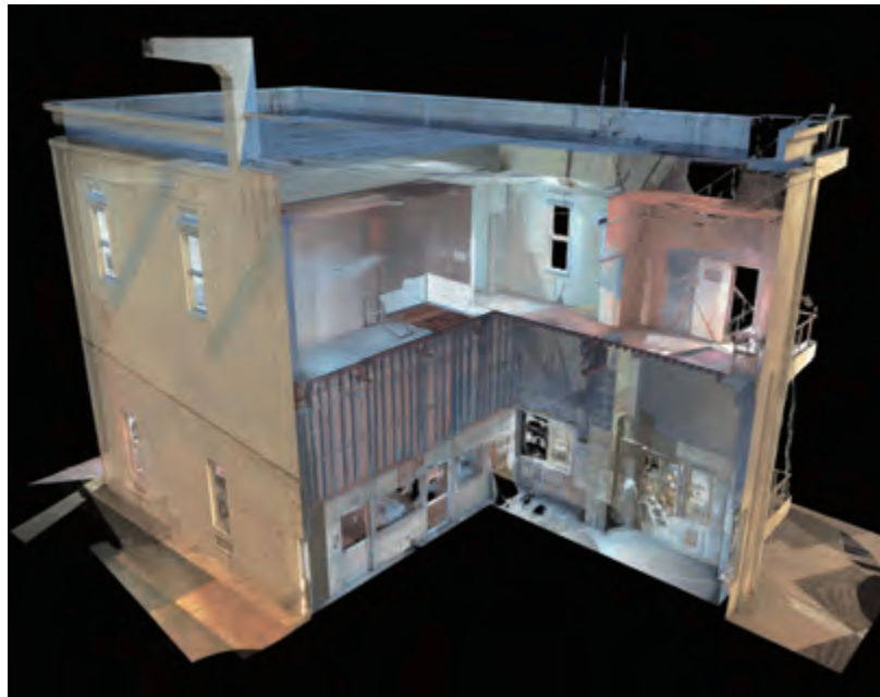
測量点の集合体からなるオルソ画像より作成した立体図では、 任意の視点からの全景や断面を見せることができる
