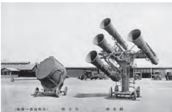
絵葉書 聴音機と照空灯 背後に高射砲を牽引した「自動貨車」(トラック)が並ぶ <ス式軽胴型150 糶照空灯> <90式大聴音機> 型式は『高射砲第一連隊概史』による
