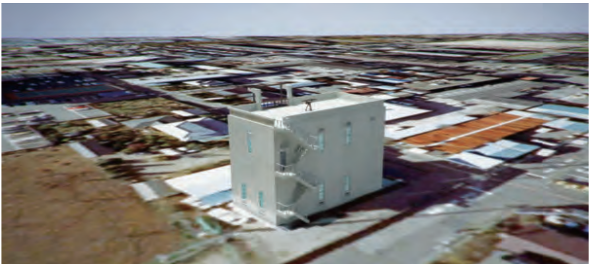
オルソ画像を補整してコンピュータグラフィックスにより3次元の画像を作成 自由に移動、回転できる
