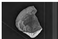
図 8-5-14 壁材に含まれていた貝殻の X 線透過像
