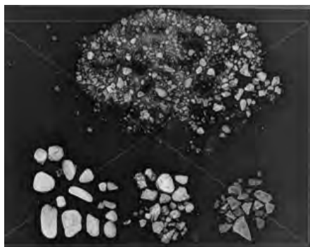
図 8-5-13 分類（4 種）後の壁材の X 線透過像
