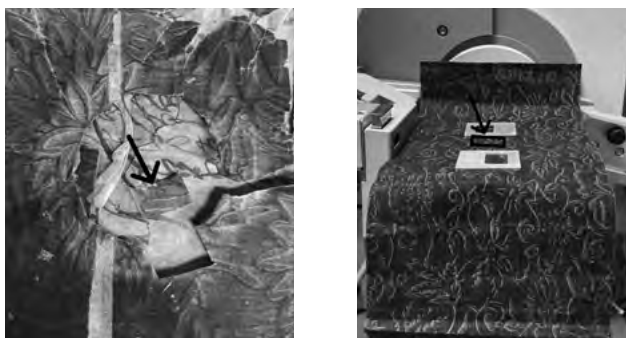
図 8-5-1 XRD 測定資料と測定箇所（P.136 にカラー写真掲載） 左：紙資料①（旧襖紙）、右：紙資料②（藍色紙）
