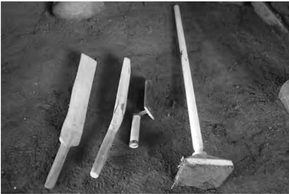
図 4-35 三和土施工使用道具
