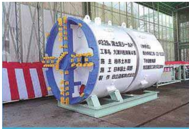
図 2-1-1 大津川左岸第4号雨水幹線で使用したシールドマシン
