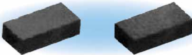
図 2-5-3 焼却灰から焼成したなのはなレンガ
