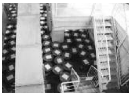
灰溶融飛灰固化物のドラム缶保管
