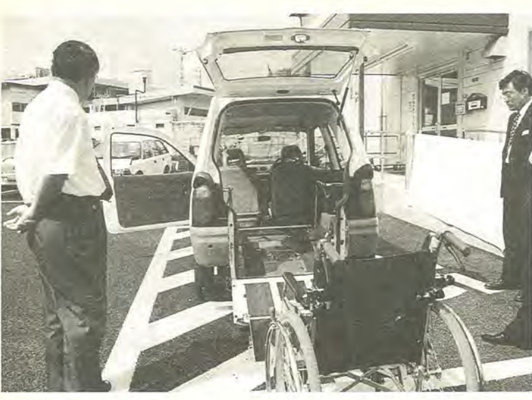
車体後部に乗降用のスロープを設置
