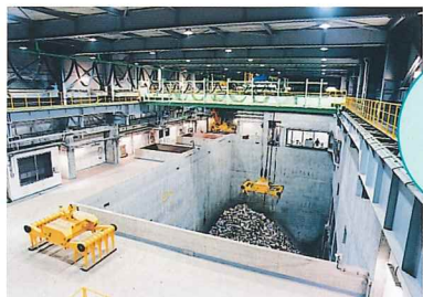
■ごみピット・ごみクレーン 運び込まれたごみは、一時ごみピットに貯留されます。ここではおおよそ1,800トン(6,000m 3 )のごみを貯留できます。
