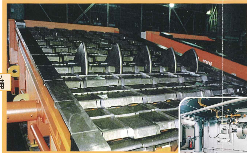
しょうきやくろ ないぶ ■焼却炉(内部) 投入ホッパへ運び込まれたごみを連続的に移送、攪拌し、850℃以上の高温で完全に燃焼・灰化して排出する一連の機能をもった焼却炉で、階段状の火格子と耐火レンガで構成されています。
