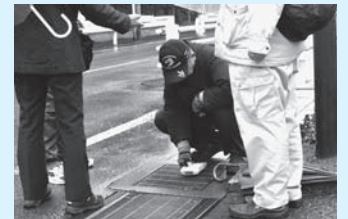
道路の側溝を測定
