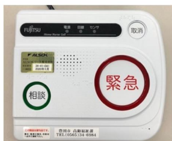
1 緊急通報システム装置
