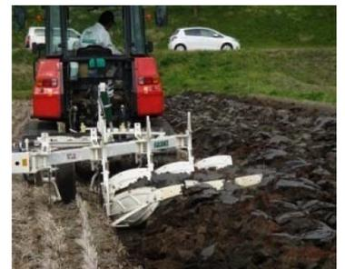
プラウ(耕起作業機)による反転耕(30cm)
