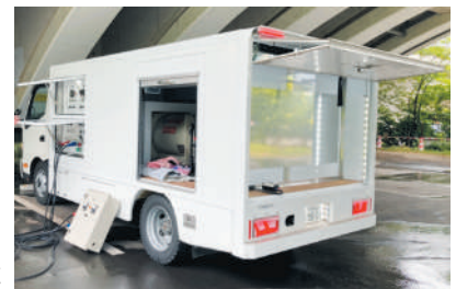
非常用電源車
