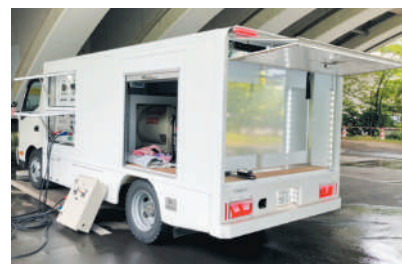
非常用電源車
