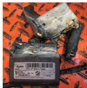
作業中に発火した リチウムイオン電池
