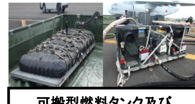
可搬型燃料タンク及び 可搬型給油装置
