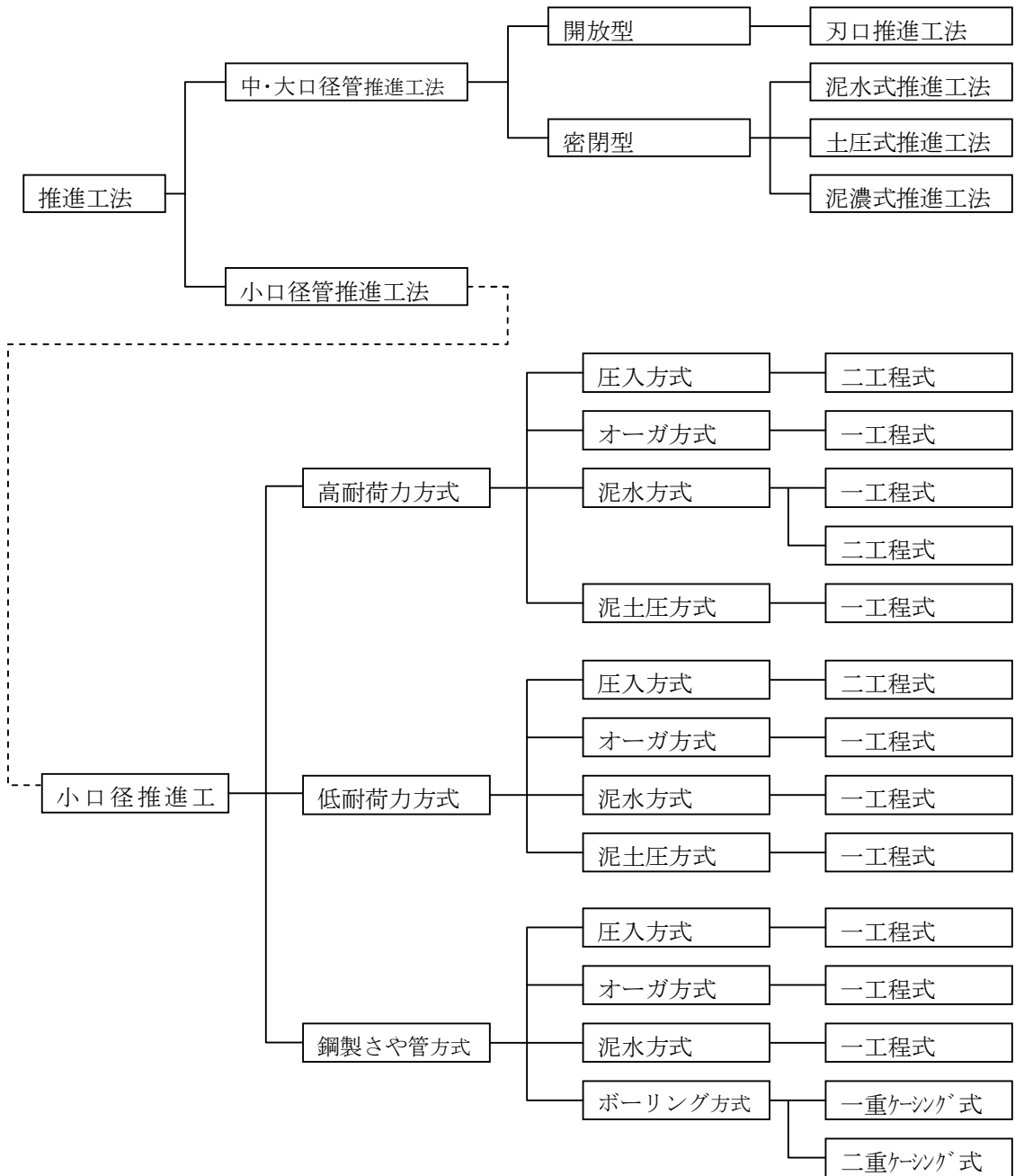
図- 3.56 推進工法の分類
