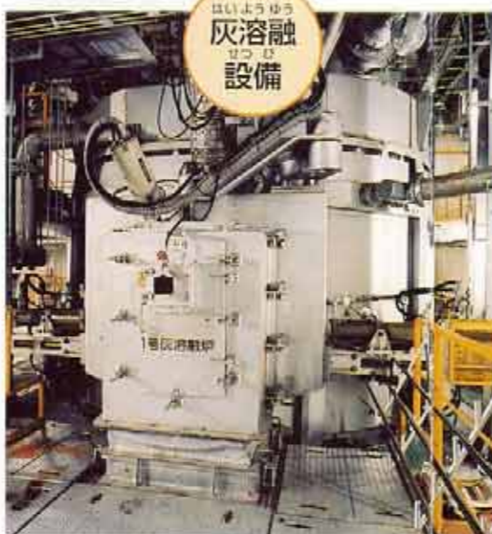
■灰溶融炉(外観) 灰を約1,200℃で溶融し、無害化するとともに、リサイクル可能なスラグにします。
