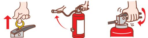
安全ピンに指を掛け上に引き抜く。ホースをはずして火元に向ける。レバーを強く握って噴射する。
